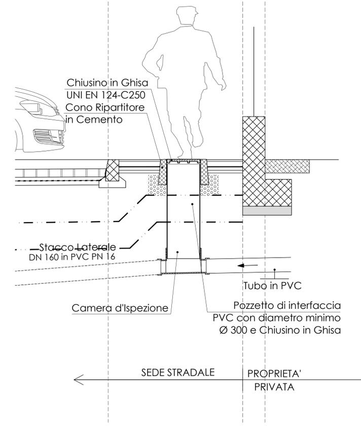
PRESCRIZIONI DI POSA: Per modalità di posa ed interferenze con altri sottoservizi, opere e strutture fare riferimento alle indicazioni realizzative e disposizioni costruttive delle linee guide dell'ente gestore della rete
