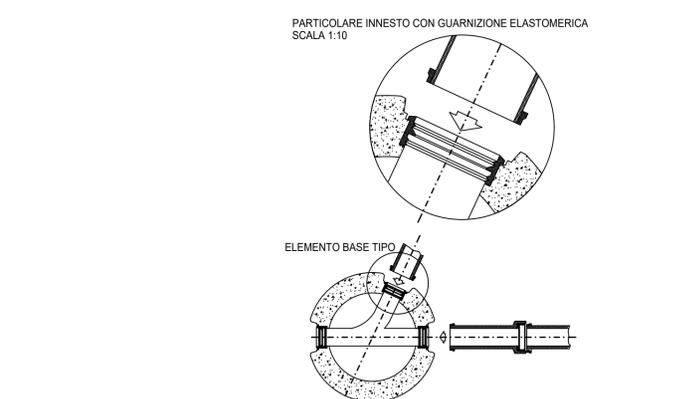
Piante degli elementi base dei pozzetti circolari d'ispezione per fognature nere.
