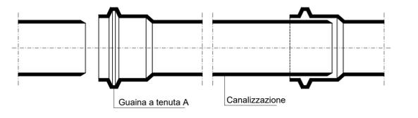
A : Guaina a tenuta in gomma formata da elementi accoppiati a sezione romboidale con labbra di tenuta idraulica e dentelli di centraggio.
